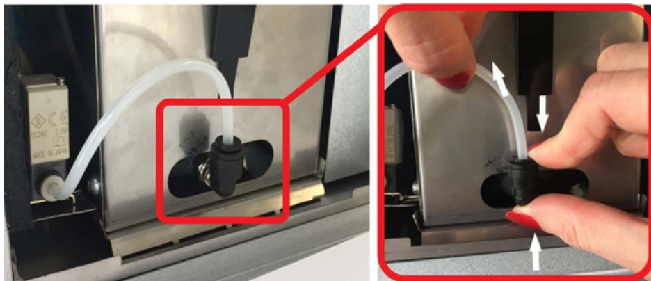
Obr. 7 Schéma rozpojení vodní trubky
